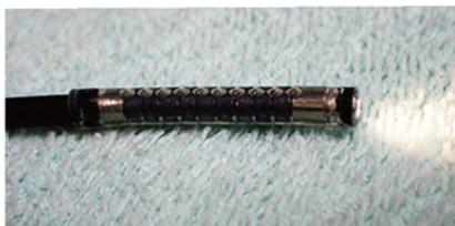
が、流石に屈曲部の材質が劣化し、ひび割れてしまいました。古い機種のため、メーカーの修理対象外でした。新規購入を考えましたが遊び心でなんとかならないかと考え、多種類を備えていたシリコンチューブを思いつきました。それが何とピッタリ。古い材質を取り除き、内径1.5mm、外径3mmのチューブをはめて外径3.4mmになりましたが、ちゃんと使えるようになりました。内部構造も見れて楽しいです。
