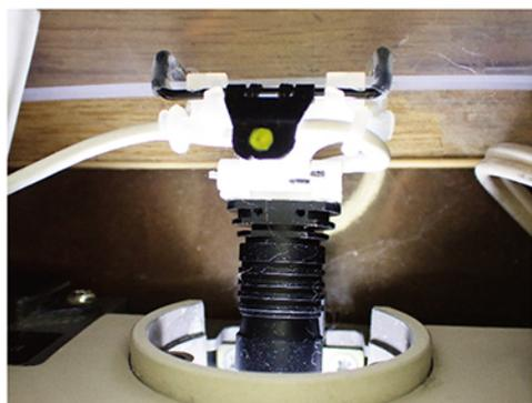
ましたら大至急に代替の機器を手配してくれて感謝感激でした。それでもその到着までの間は困ります。そこで、メガネに取り付ける白色のLEDスポットライトを、電球装着部に置き、電球用の色温度補正のフィルターをはずしたらまったく問題なく使用できるようになりました。ゆっくり買い替えを考えることにしました。
