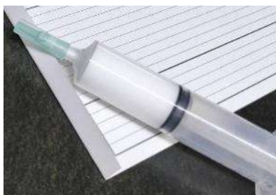
図3 紙用ボンドを塗りやすいシリンジに入れて使用
