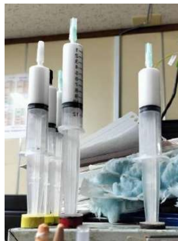
図4 シリンジの下部分に磁石をつけてスチール台に乗せてすぐ手に取りやすいようにしている
